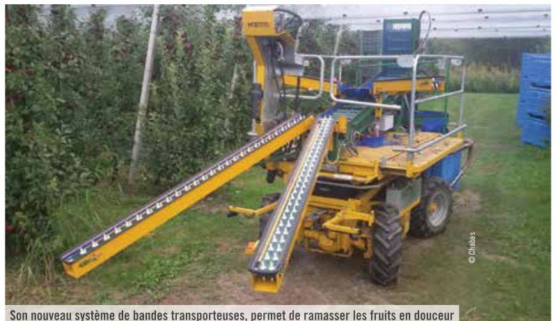
Son nouveau système de bandes transporteuses, permet de ramasser les fruits en douceur
